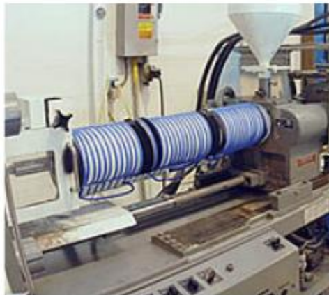
Figura 26. Extrusora con cilindro calentado mediante inducción
