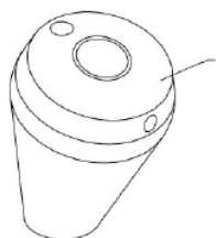
Imagen N° 2 fuente propia de la boquilla arandela modificada del lavador de carcasa
